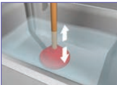
ب – حرکت عمودی لوله بازکن
