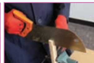
ث - اره کاری شیار بازوی چوبی
